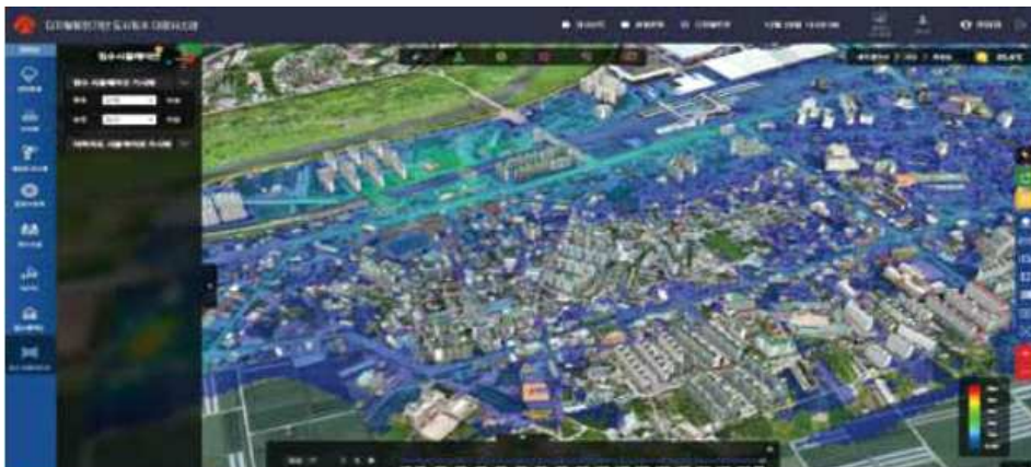
그림 18. 디지털 트윈 기반 도시 침수 스마트 대응 시스템 개념도
