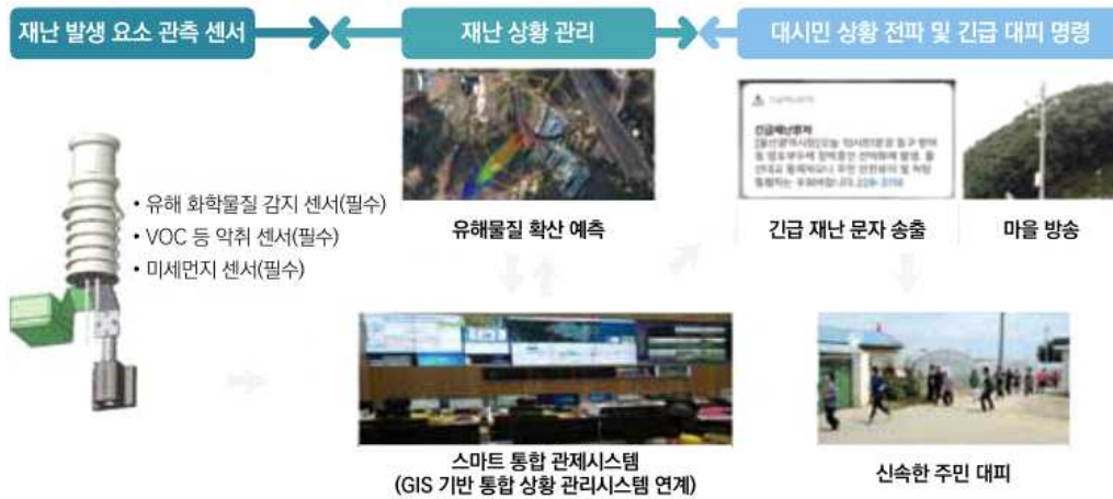
그림 21. 스마트 통합 관제시스템 개념도
