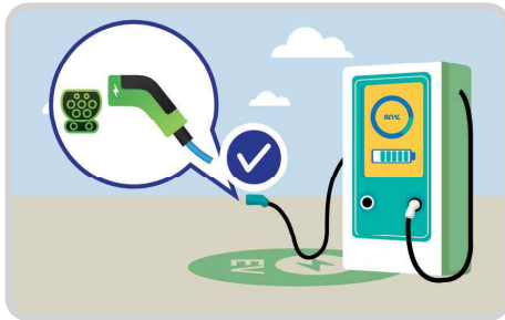
① 충전 전 케이블이나 커넥터 손상여부 확인
