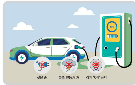
② 이럴 때는 사용하지 말 것 ㉠ 젖은 손 ㉡ 폭풍, 천둥, 번개 강제 "ON" 금지 ㉢ 충전기 전원이 차단되었을 때 강제 "ON" 사용금지
