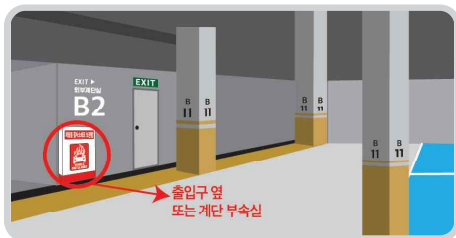
① 질식소화포, 상방향 살수장치는 출입구 옆에 두거나 계단 부속실에 보관
