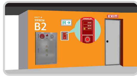
④ 스프링클러 수동조작함(SVP)은 피난계단 출입구 옆에 설치
