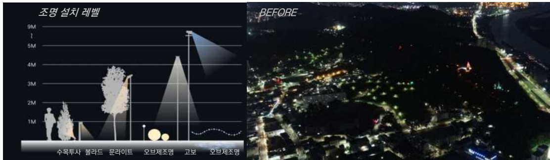
[그림 5.26] D-1 조명기구 설치레벨 개념도
